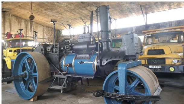
Rouleau compresseur à vapeur (12 tonnes)
